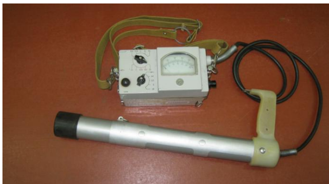
Рис. 5.1. Геологорозвідувальний прилад СРП 68-01
