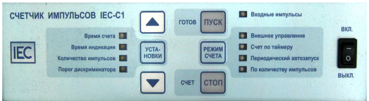
Рис. 1.9. Панель управління лічильника імпульсів ІЕС-С1
